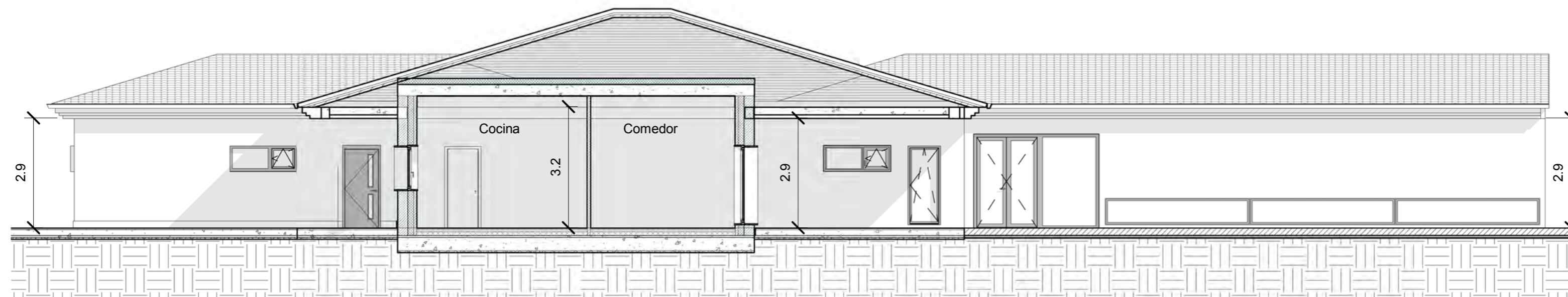
01_Sección Longitudinal por Cocina y Comedor 1 : 100
