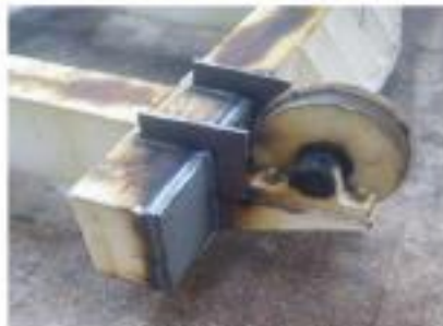
Detalle rueda deformada y doblada
